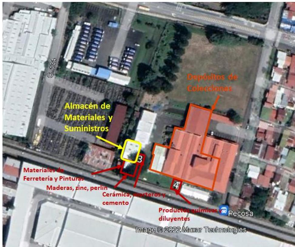
Con rojo se señalizan los depósitos de materiales que carecen de extintores
